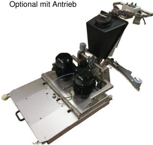
Das Verfahren funktioniert 3-stufig unter Einwirkung von Dampf, umweltfreundlichem Reinigungsmittel und anschliessender thermomechanischer Reinigung. Mit diesem Verfahren kann hartnäckiger Schmutz wie Kaugummi, Teerflecken, Harze, Öle und so weiter porentief von grossen Oberflächen äusserst wirtschaftlich in kurzer Zeit bei minimalem Wasserverbrauch von ca. 2.5 L/Min entfernt werden. Die verblüffenden Resultate sprechen für sich.
